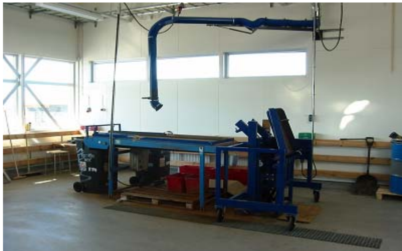
Batterisortering. Batterikärlet töms med hjälp av en kärlvändare över på ett rullband där batterierna sorteras för hand.
